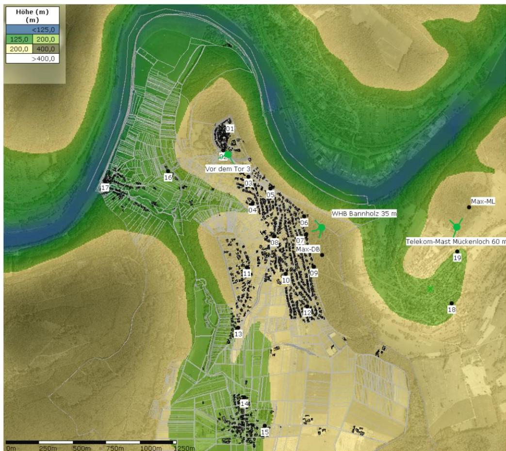
Abb. 3: Lage der Mobilfunkstandorte und der Bezugspunkte auf Basis des Höhenmodells<sup>1</sup>
